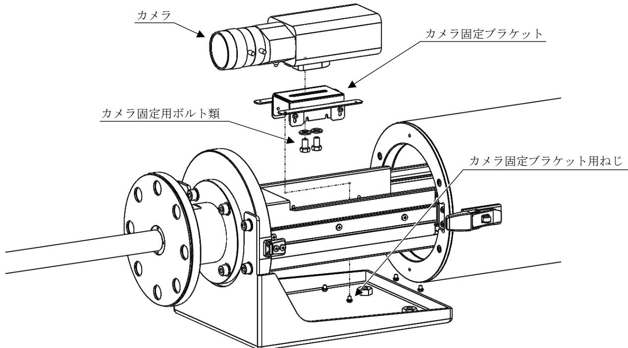
カメラはカメラ固定用ボルト類を使用し、カメラ固定プラケットを介して締結されています。
