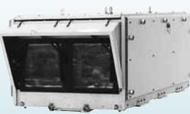
**概要** キヤノン高倍率ズームレンズと高感度カメラを収納し、屋外の諸条件で鮮明な画像を得られるよう保護します。ファン・デフロスター・ヒーター・ワイパーを標準装備。昼夜間に亘る監視を行えるように可視光及び赤外線カメラを収納可能とした全天候型カメラハウジングです。
